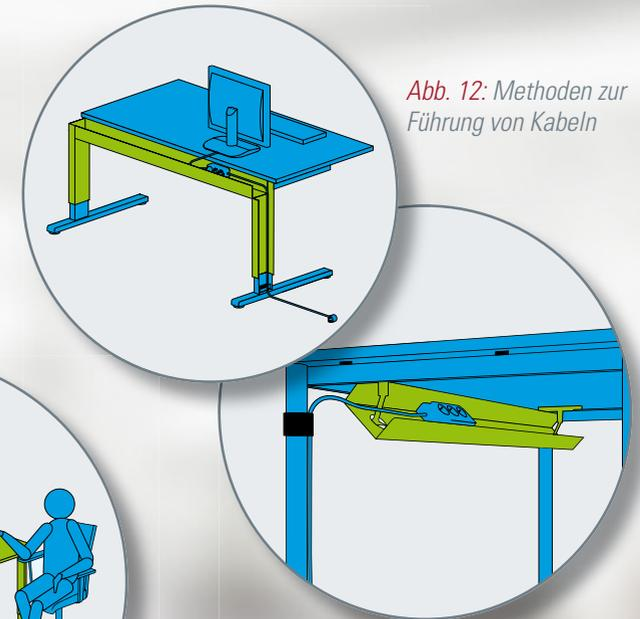
Abb. 12: Methoden zur Führung von Kabeln
